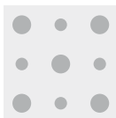
R - perforacja okrągła naprzemienna
